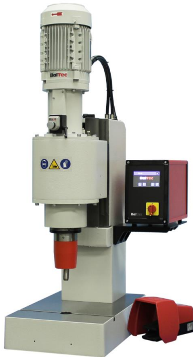
EN 35 -kompletter Arbeitsplatz als autonome Maschine
